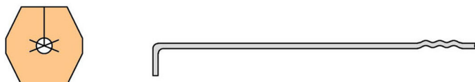
▲ Figure N°4 : Exemple d'attache de liaison accompagnée d'une rondelle anti-goutte d'eau à gauche
